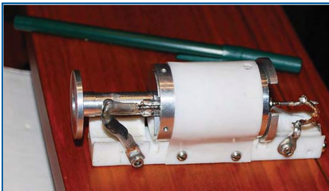
Fig. 1 Le premier laser fonctionnel, inventé par T. H. Maiman en 1960. (Image du domaine public.)
